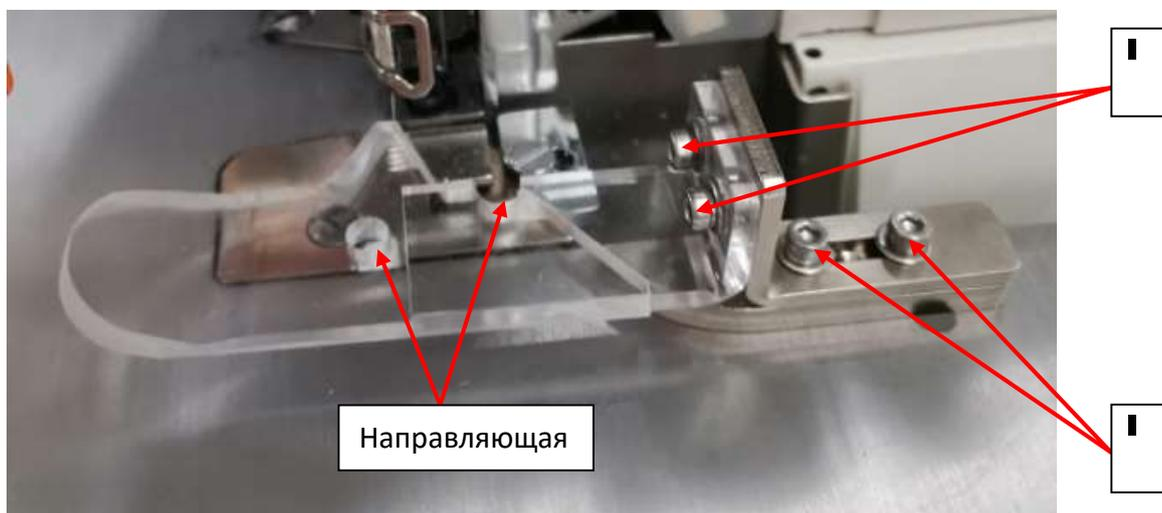
Как показано выше: Винт 5 регулирует положение направляющей пластины вверх и вниз, чтобы сделать ткань плоской и гладкой;
