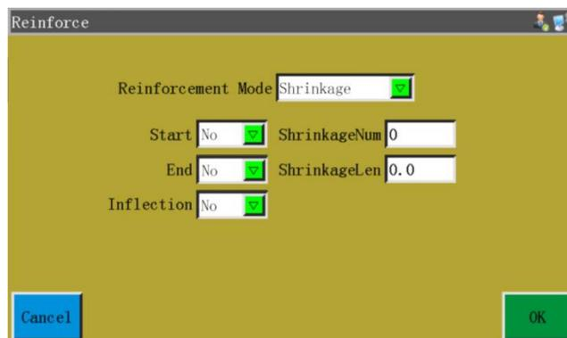
Лямбдоидальный шов: V- или N-образная закрепка. При установке параметров, как показано на левом рисунке ниже, имеет место эффект усиления, показанный на правом рисунке.
