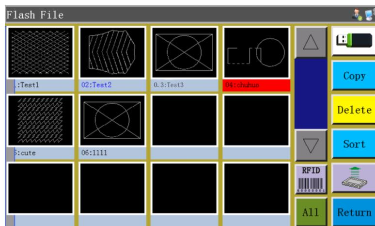
Системная память может хранить до 999 файлов обработки, при этом общий объем не должен превышать 128 Мб. Поддержка имен файлов на китайском и английском языках (с учетом регистра); имя каждого файла может содержать до 15 китайских символов или 30 знаков (отображаемое количество знаков может различаться в зависимости от интерфейса). В случае неправильного формата файла обработки файла или повреждения файла предварительный просмотр не отображается.
